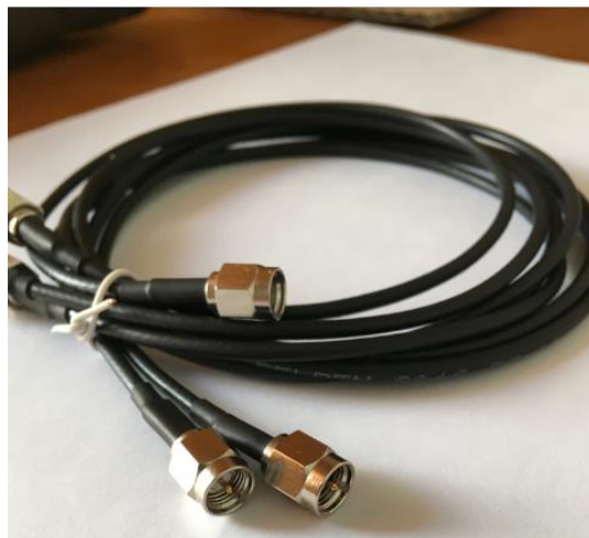
Figura 3.6 Cables terminados con terminales SMA acopladas
