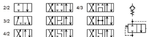
Figura 5 Válvulas de control direccional (de las Heras, 2011).
