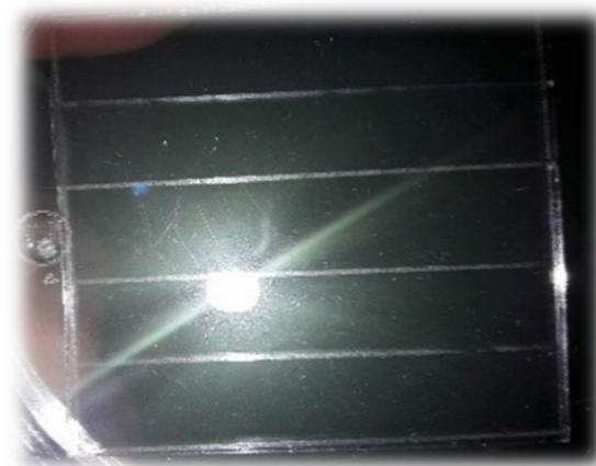
**Figura 2-7. Ejemplo de los cortes requeridos en las celdas solares.**
