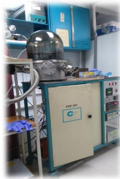
**Figura 3-1. Equipo para depósito de películas delgadas por la técnica de Sputtering, Laboratorio de Celdas Solares del CINVESTAV-IPN Unidad Mérida.**
