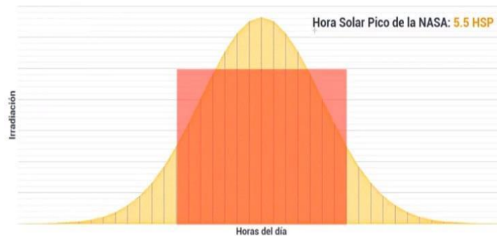
Figura 5.2: Gráfica de la generación de energía de un panel fotovoltaico durante el día y las horas solares pico.
