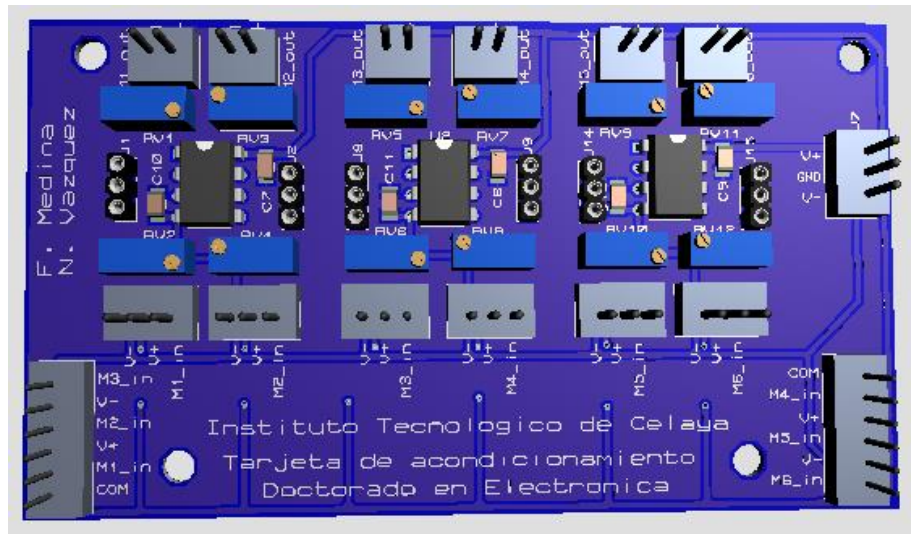
Figura A1.19: Vista 3D de la tarjeta de acondicionamiento propuesta.
