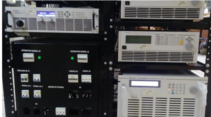
Figura 5.1: Equipo de laboratorio, conjunto de fuentes de alimentación de corriente directa y corriente alterna dispuesto para prueba de prototipos en laboratorio.
