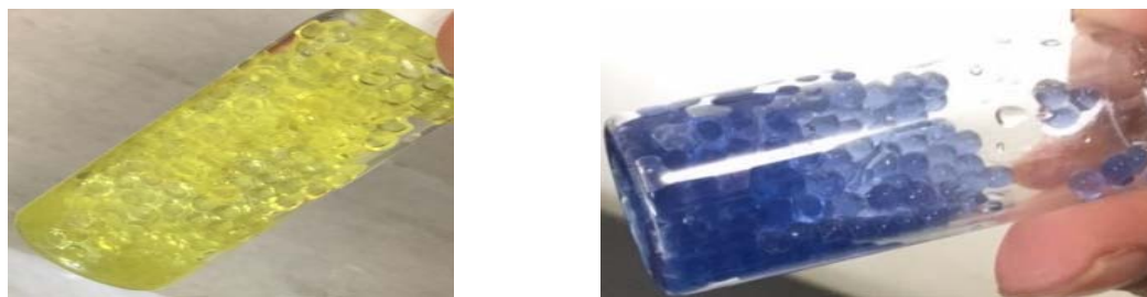
Figura 3.26 Encapsulados de los pigmentos
