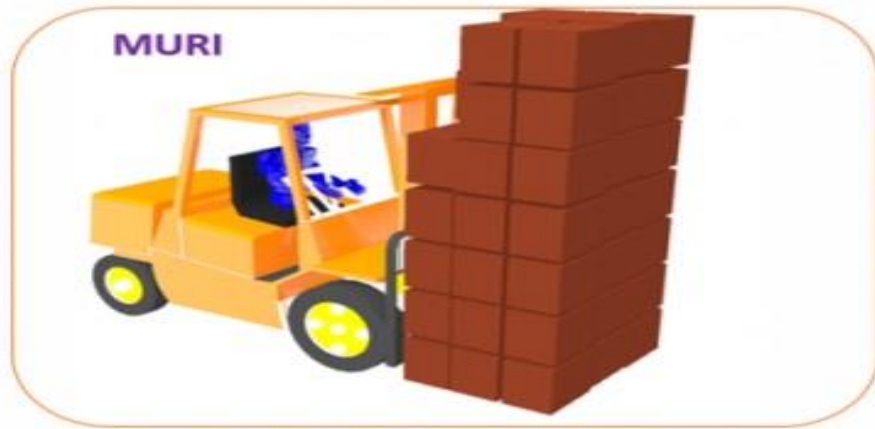
Figura 20 Muri o sobrecarga (Solutions, 2019)
