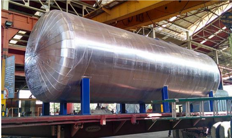
Imagen 2.5. Tanque o recipiente acumulador de fluidos.
