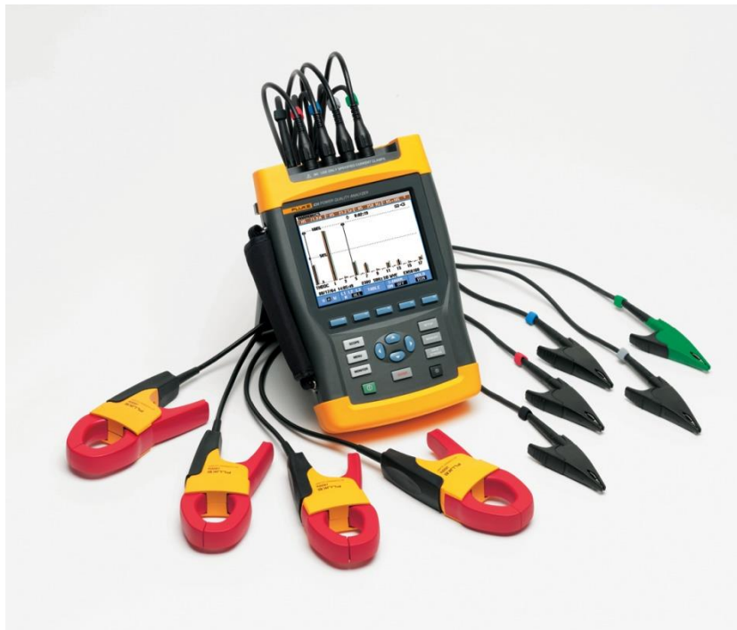
Fig. 2.5 Analizador Fluke 434 con sus sondas de tensión y pinzas amperimétricas.
