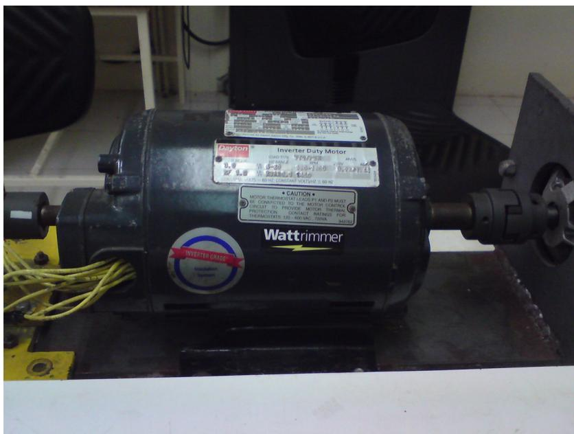
Figura 5.4: Motor de inducción Jaula de ardilla.
