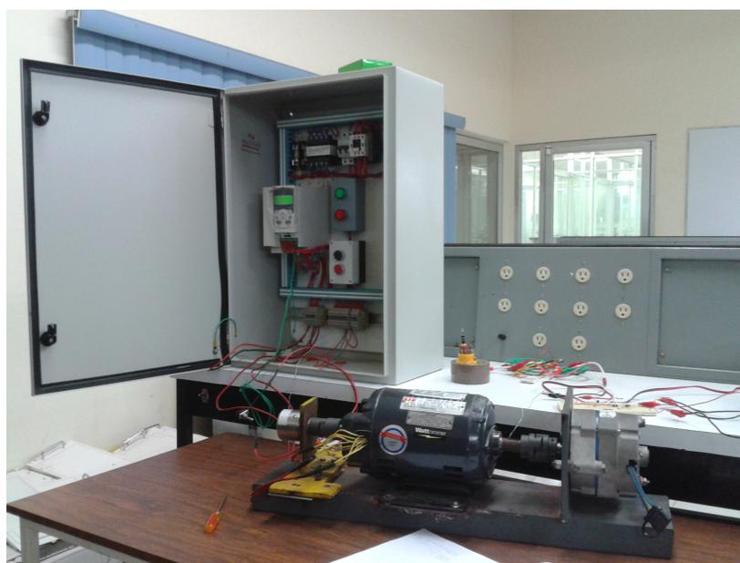
Figura 5.5: Conexión del motor con el variador ABB.
