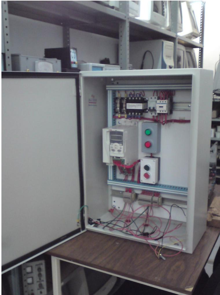
Figura 5.6: Variador de velocidad de la marca ABB.
