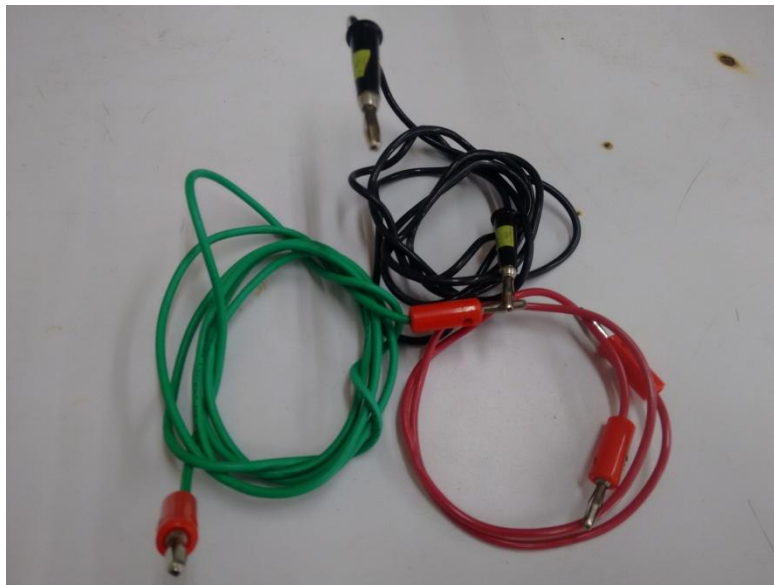
Figura 6.3. Cables con conectores banana.
