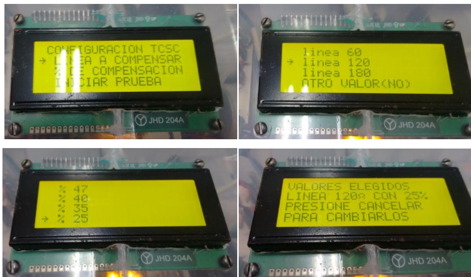
Figura 6.11. Pantallas de la configuración del prototipo de TCSC para la línea de 120.
