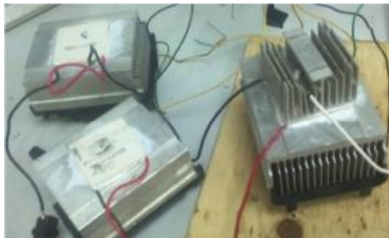
Figura 3.8 Conexión en serie de celdas peltier.
