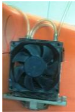
Figura 3.7 Disipador convertido en radiador.
