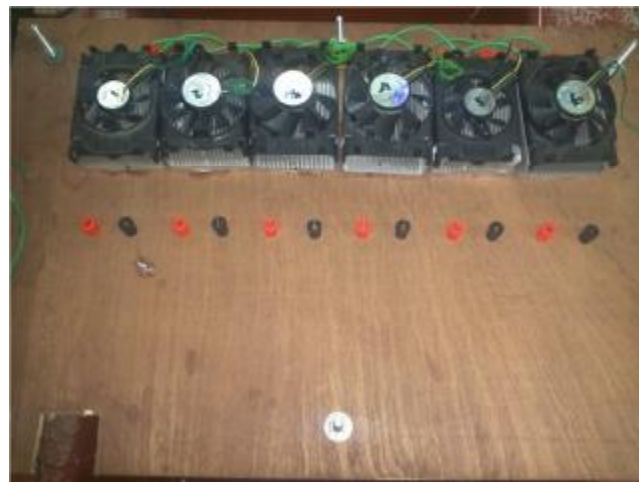
Figura 6.8 Celdas peltier como carga del prototipo.
