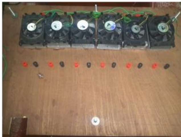
Figura 4.29 Celdas peltier como carga del prototipo.
