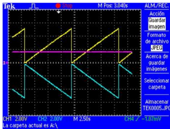
Figura 5.1 Rampas del sistema y señal de control.
