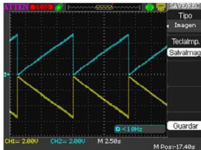
Figura 4.15 Señales diente de sierras con corrimiento.
