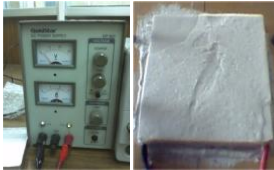
Figura 3.1 Celda peltier congelada aplicando 1 volt.
