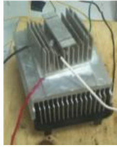
Figura 3.3 Pérdida de enfriamiento en la cara fría.
