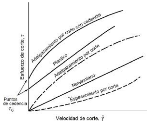
Figura 1.46. Curvas de flujo (esfuerzo de corte vs velocidad de corte) para diferentes tipos de comportamientos de flujo.
