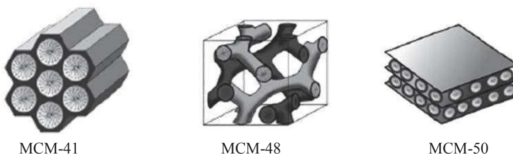
Figura 1.2. Estructura de materiales mesoporoso [15].
