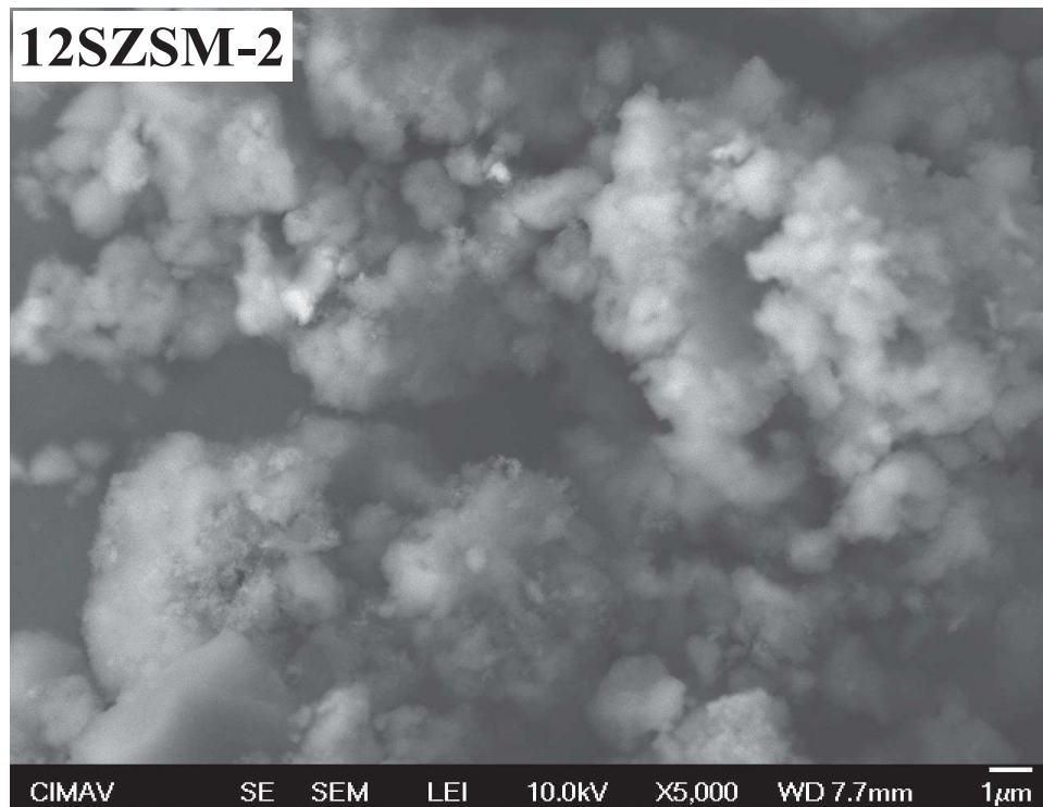
Figura 3.25. Microscopía electrónica de barrido ZSM sulfatado con 12% en peso de iones sulfatos y calcinado a 500°C por 3 h.
