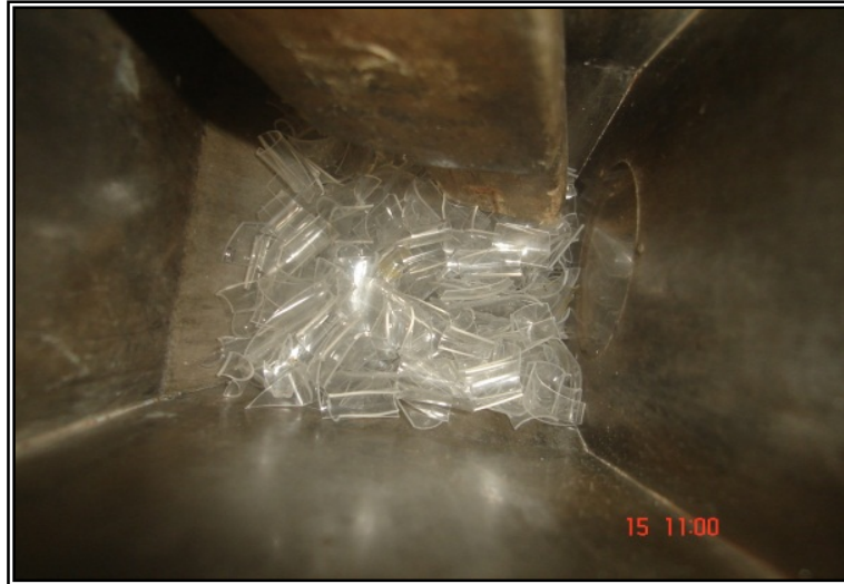
Figura 2.13 R-PET a la entrada del extrusor
