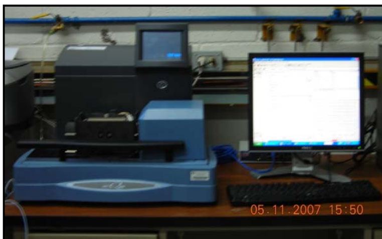
Figura 2.18, TGA-DSC simultáneo, SDT Q600 TA Instrumentes.
