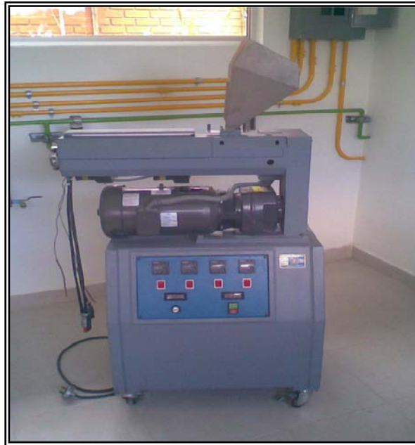
Figura 2.15. Procesamiento de las mezclas en el Extrusor Beutelspacher.
