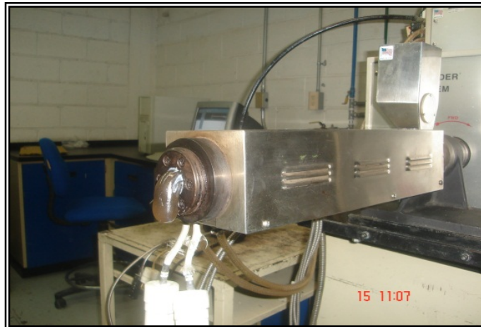
Figura 2.14 Procesamiento de las mezclas en la Cámara de mezclado.
