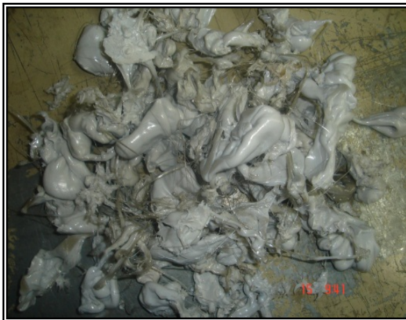
Figura 3.3 R-PET, procesado en el extrusor.
