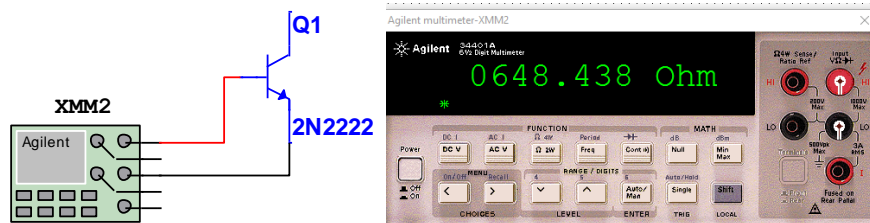
Fig. 9 unión base-emisor polarizada directamente.
