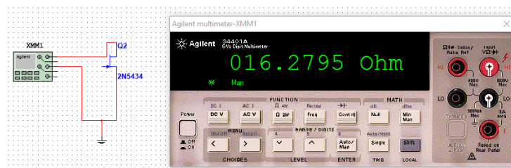
Fig. 1 resistencia drenaje-fuente en un JFET de canal n.
