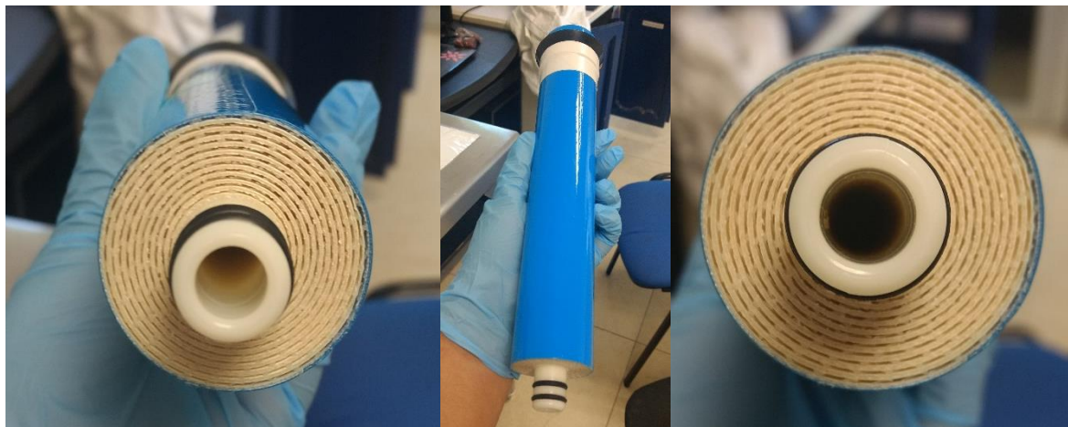
Figura 2.13 Membrana de ósmosis inversa de configuración enrollada.
