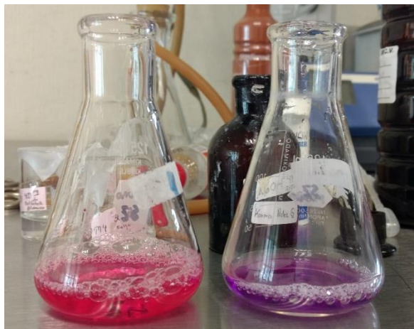
Figura 2.9 Cambio de rosa a púrpura para la determinación de calcio.
