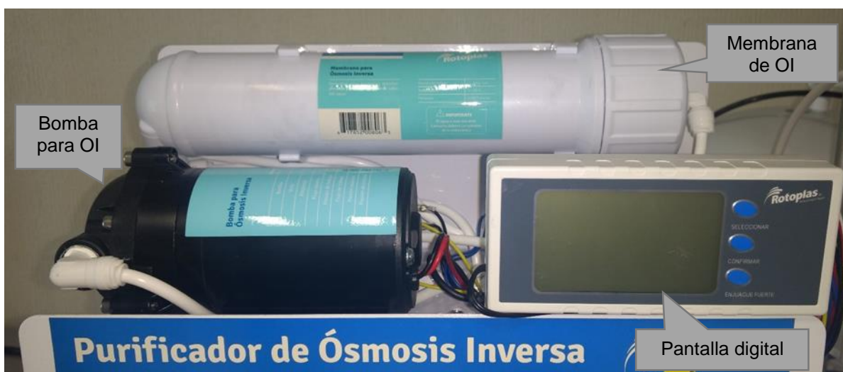
Figura 2.14 Sistema de filtración de OI.
