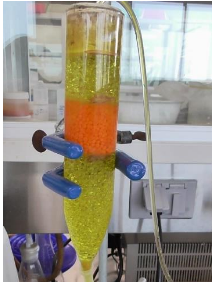
Figura 3.31 Columna de adsorción de 3 cm de altura de lecho en operación
