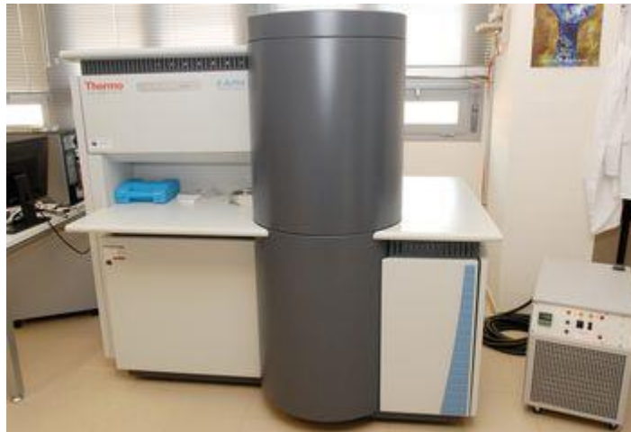
Figura 2.2 Equipo ThermoScientific K-Alpha X-Ray Photoelectron Spectrometer para el análisis XPS
