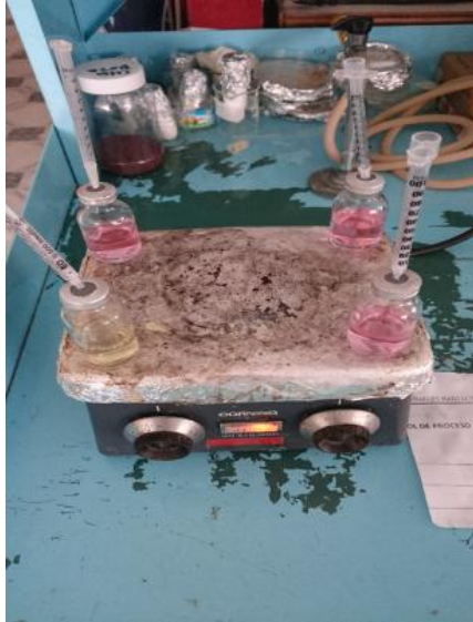
Figura 2.2 Preparación de medio de cultivo anaerobio por Método de Hungate
