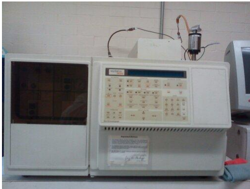
Figura D1 Cromatografo utilizado para la determinación de biohidrógeno
