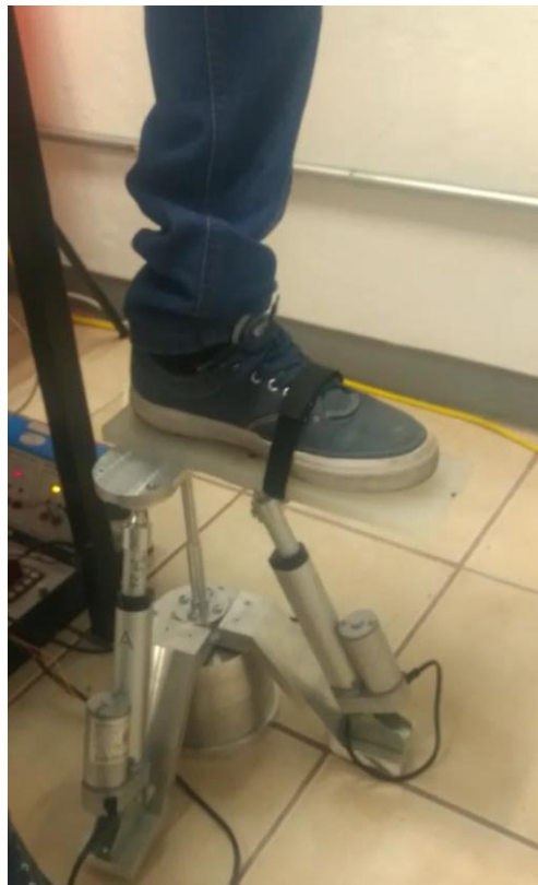
Fig. 4.5-17 Se muestra el pie de un individuo atado al efector final del mecanismo para las pruebas con carga.
