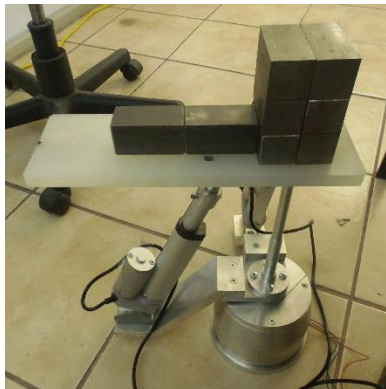
Fig. 4.5-18 Se muestra el peso de prueba sobre el efector final para las pruebas con carga del actuador rotativo.
