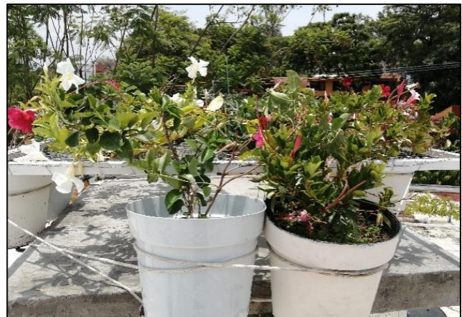
Figura 4. 43. Sujeción de las macetas colocadas sobre la cavidad experimental
