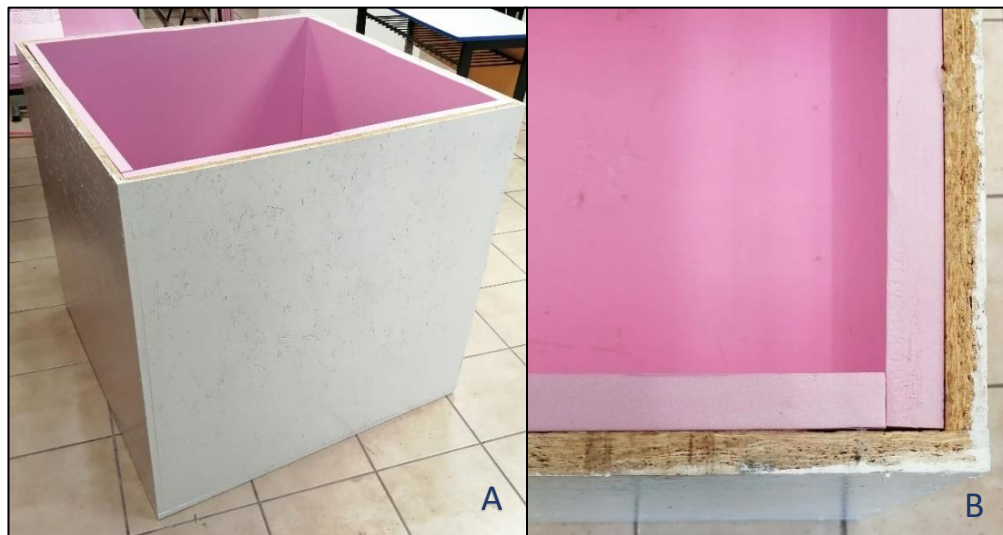
Figura 4. 19. Cavidad experimental construida, A) Exterior y B) Interior
