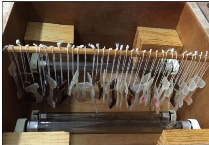
Figura 9. Probetas en irradiación dentro de la cámara UV a 254 nm.
