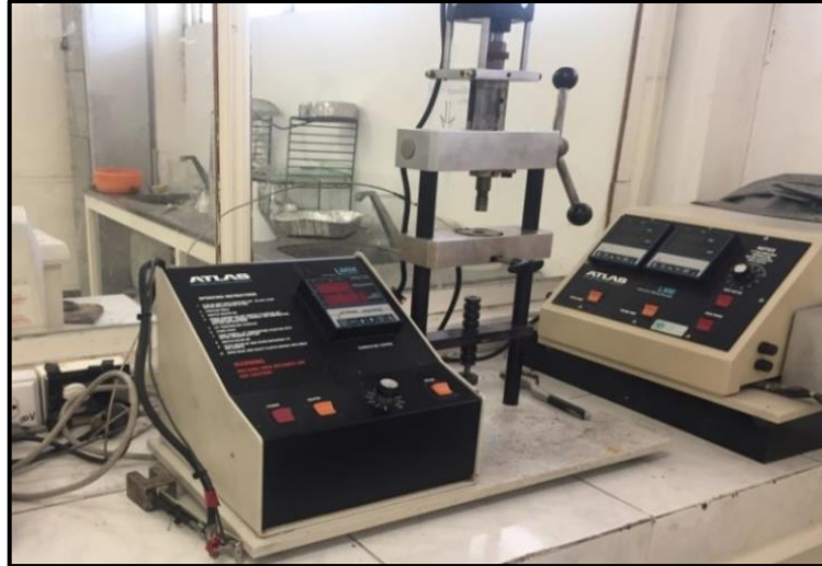
Figura 8. Inyectora utilizada en la elaboración de las probetas, marca Atlas.
