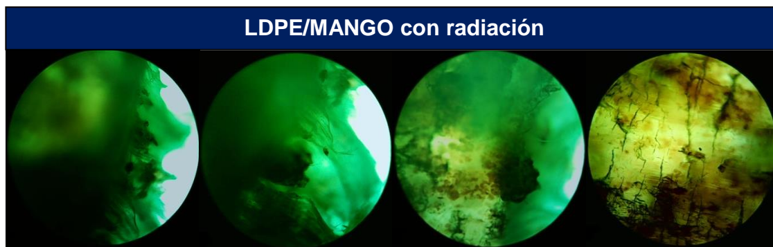
Figura 38. Imágenes tomadas con microscopio óptico con 10X de magnificación de LDPE/mango con radiación.
