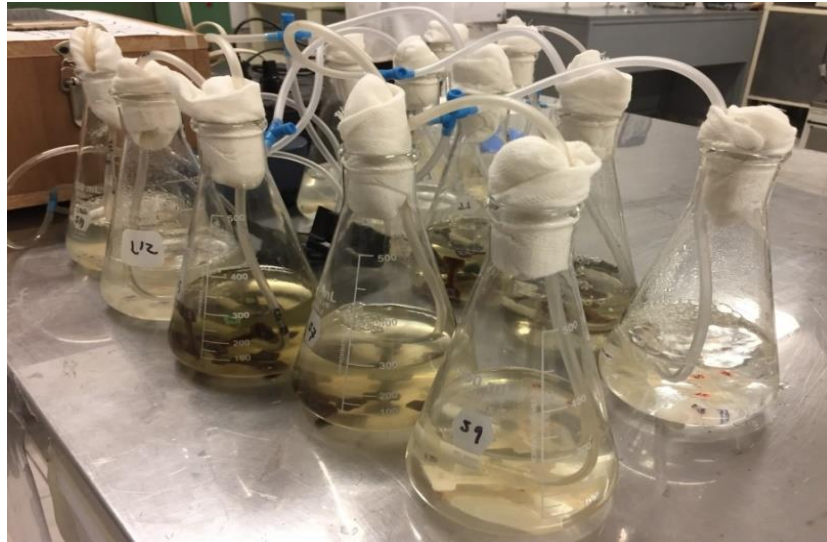
Figura 12. Biodegradabilidad de las probetas con los diferentes tipos de humus.
