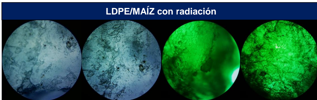
Figura 36. Imágenes tomadas con microscopio óptico con 10X de magnificación de LDPE/maíz con radiación.
