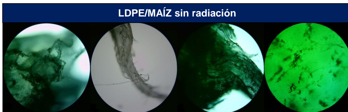
Figura 35. Imágenes tomadas con microscopio óptico con 10X de magnificación de LDPE/maíz sin radiación.
