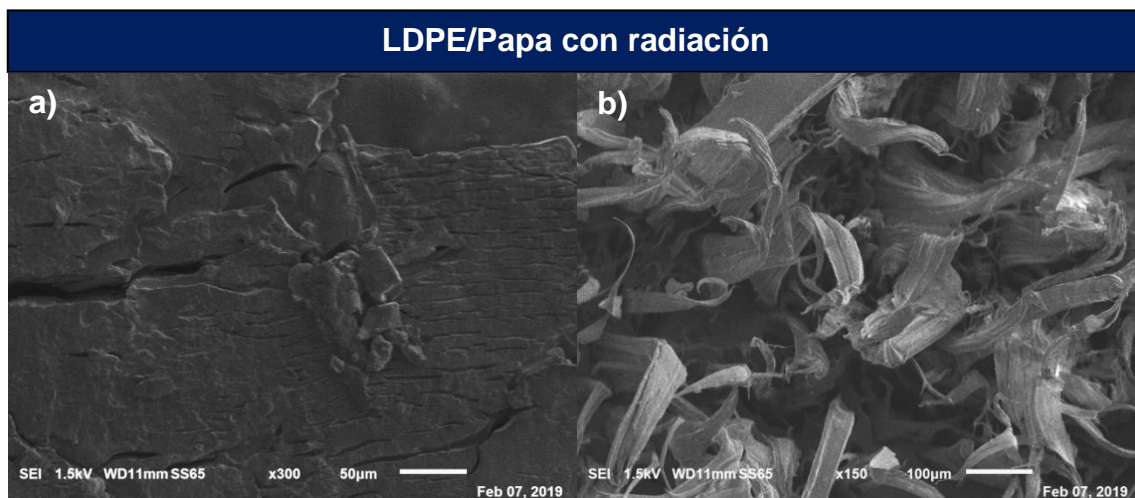
Figura 32. Micrográficas de a) superficie y b) fractura de la probeta de LDPE/papa después de pre-tratamiento de radiación UV.
