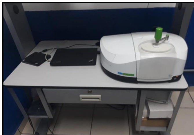
Figura 13. Espectrofotómetro de Infrarrojo con transformada de Fourier, PerkinElmer Spectrum Two.
