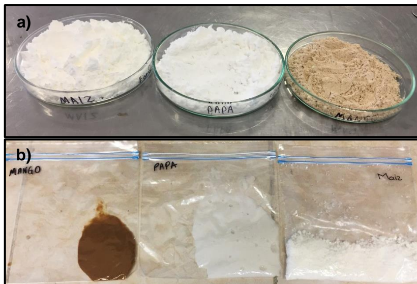
Figura 16. a) Almidón seco de maíz, mango y papa. b) Obtención del TPS de maíz, mango y papa.
