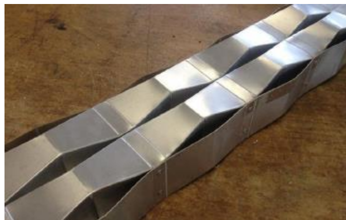
Figura 22. Viga origami, modelo de aluminio. Tomada de (Li & Zhong, 2019)
