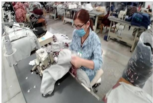
**Ilustración 15. Operaciones en maquina Overlock**
