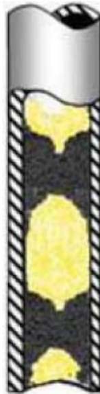
Ilustración 5 Flujo tapón o bache para tuberías verticales.
