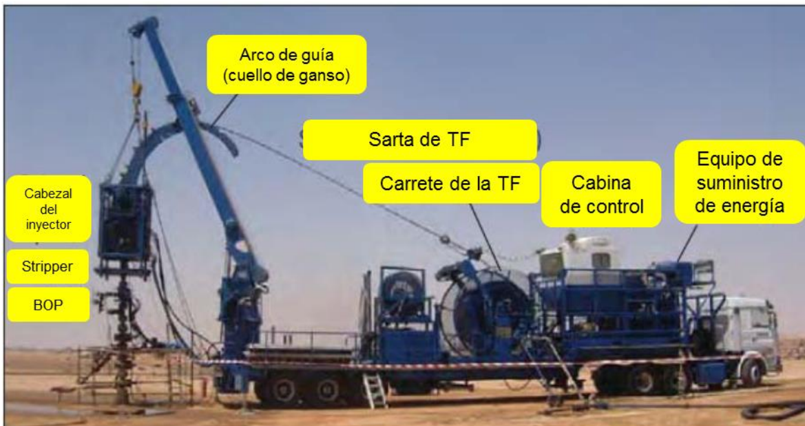
Ilustración 10 Componentes principales de la unidad de tubería flexible.
