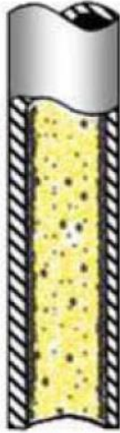
Ilustración 7 Flujo anular para tuberías verticales.
