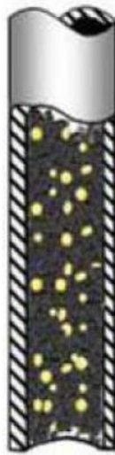
Ilustración 4 Flujo burbuja en una tubería vertical.
