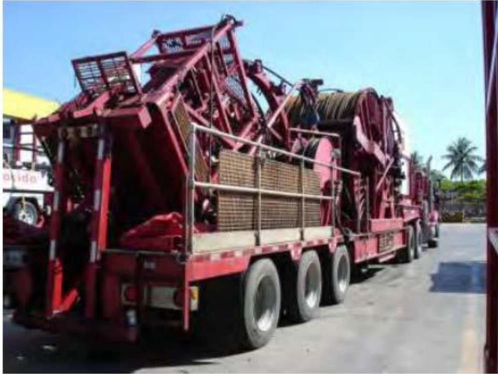
Ilustración 9 Equipo de tubería flexible.
