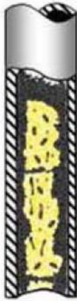
Ilustración 6 Flujo transición para tuberías verticales.
