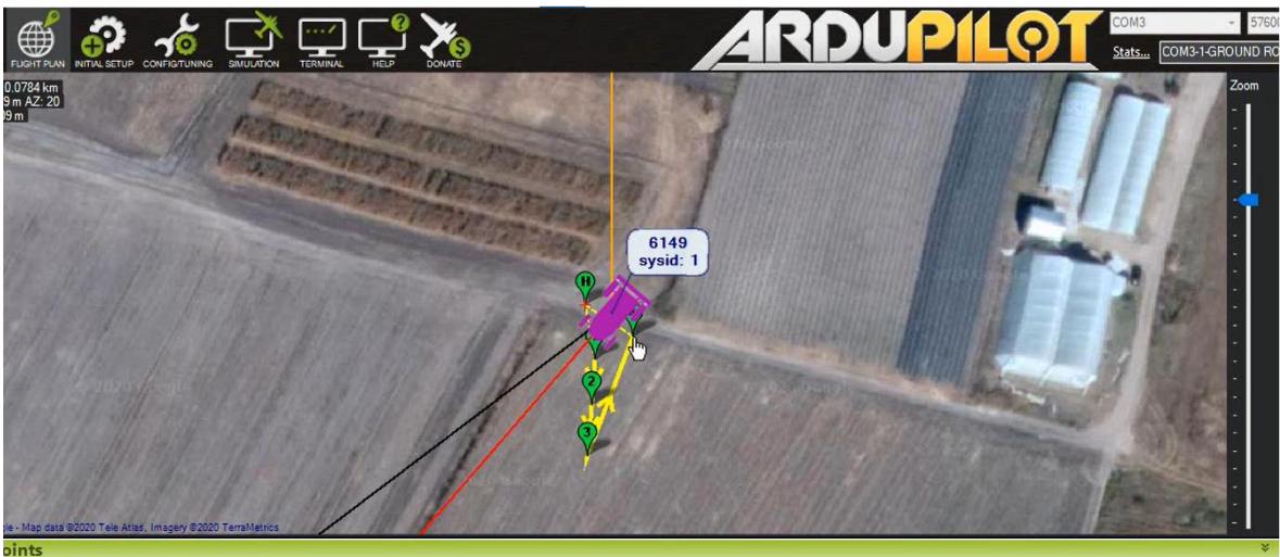
Figura 4-3 Programación de una trayectoria de 4 puntos Fuente: UPIDET, TecNM/IT Durango
