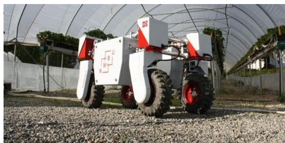
Figura 0-2 Thorvald II con extremidades contraídas para operación en interiores Fuente: https://sagarobotics.com/
