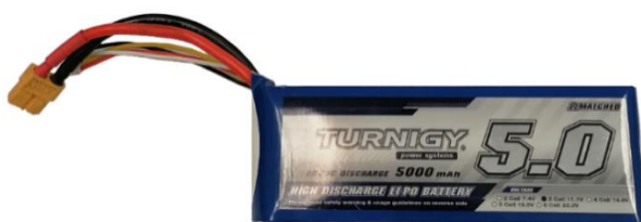
Figura 3-11 Batería de 3 celdas, Polímero de Litio (LiPo) a 11.1v, 5000mAh Fuente: UPIDET, TecNM/IT Durango
