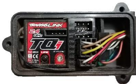
Figura 3-8 Módulo de radiocontrol Traxxas Link 2.4GHz, TQi Fuente: UPIDET, TecNM/IT Durango
