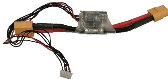
Figura 3-6 Módulo de poder de 90A Fuente: UPIDET, TecNM/IT Durango
