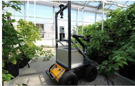
Figura 0-4 Husky UGV realizando tareas de polinización Fuente: https://clearpathrobotics.com/
