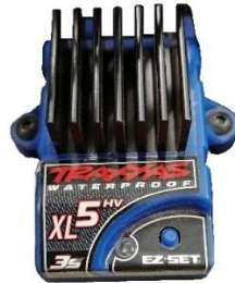
Figura 3-7 Módulo ESC XL5HV Fuente: UPIDET, TecNM/IT Durango
