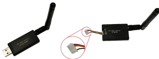
Figura 3-15 Módulo en tierra 433MHz (izq.), Módulo para el Pixhawk 433MHz (der.), genéricos Fuente: UPIDET, TecNM/IT Durango
