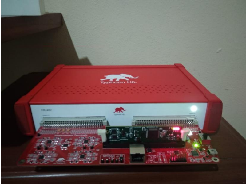
Figura 4.1. Configuración Hardware in the Loop
