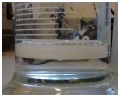
Figura 22. Desplazamiento del líquido por inmersión del nanocompuesto.
