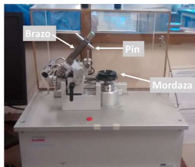
Figura 13. Tribómetro CSM Instruments con mordaza para pruebas en seco.
