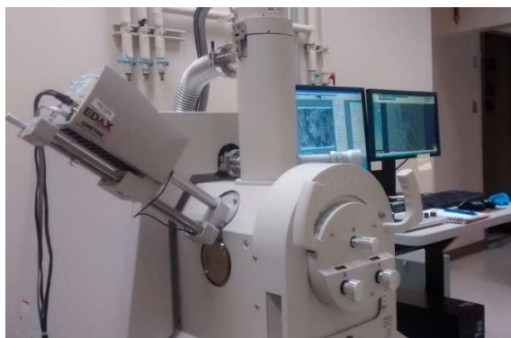
Figura 10. Equipo MEB HITACHI 1510 con detector EDAX para análisis EDS.
