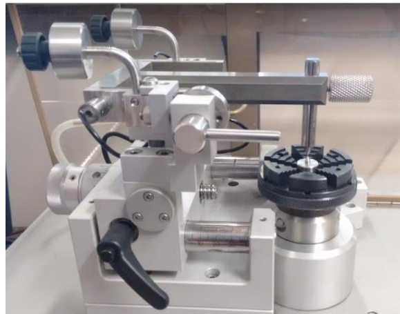
Figura 3.10 Montaje de probeta recubierta para ensayo.
