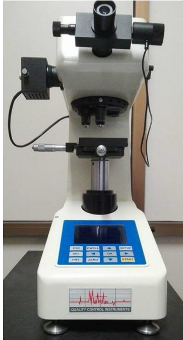
Figura 3.9 Súper Micro-Durómetro Vickers/Knoop, SMVK-1000ZS (3009).
