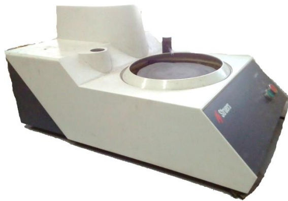
Figura 3.6 Pulidora electromecánica Struers Labpol-1
