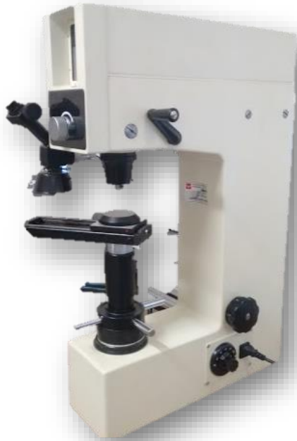
Figura 3.4 Durómetro universal TH722
