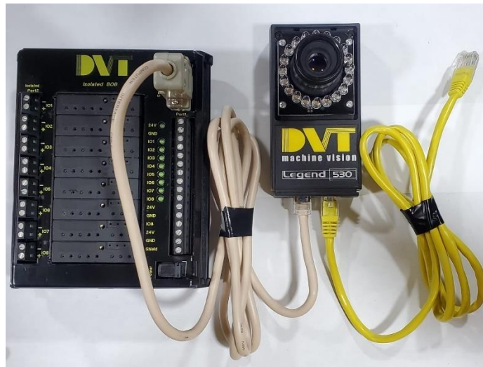
Figura 22: Conexión cámara DVT Legend 530 – DVT Isolated BOB.
