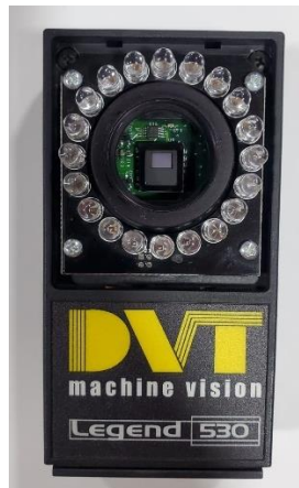
Figura 17: Sensor CCD de cámara DVT Legend 530.
