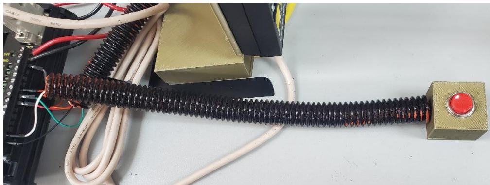
Figura 41: Montaje para gatillo de inspección externo.
