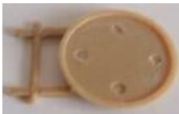
Figura 24 Marcas debido al uso de expulsores [11].
