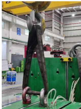
Figura 34 Cáncamos y eslinga utilizados.
