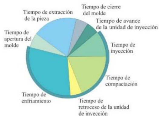
Figura 9 Tiempos en el ciclo de inyección [5]
