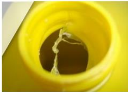
Figura 23 Ejemplo de rebaba en pieza moldeada [11].
