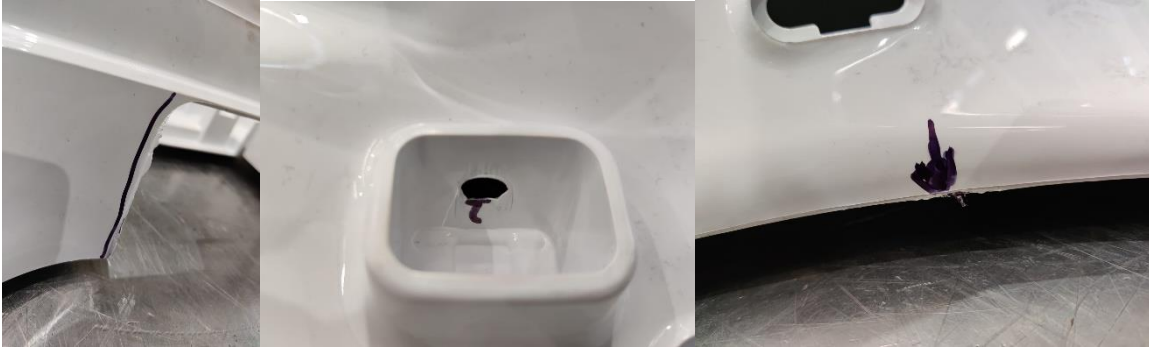
Figura 45 Zonas con rebaba en la pieza.
