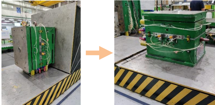
Figura 35 Proceso para voltear el molde
