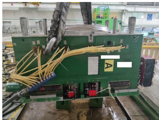
Figura 69 Molde sin presencia de fugas.
