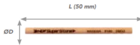
Figura 6.- Guía para las dimensiones de una piedra cerámica redonda de 50mm.
