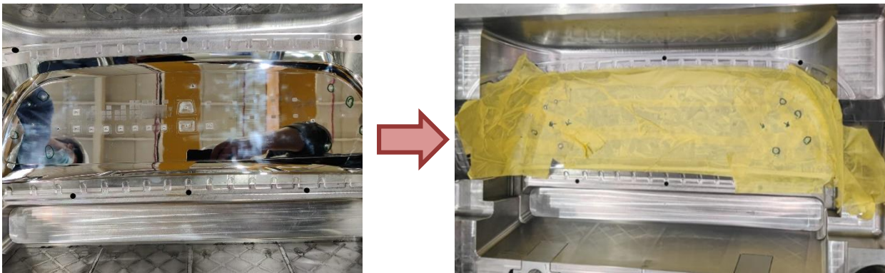
Figura 22.- Protección de la cavidad.
