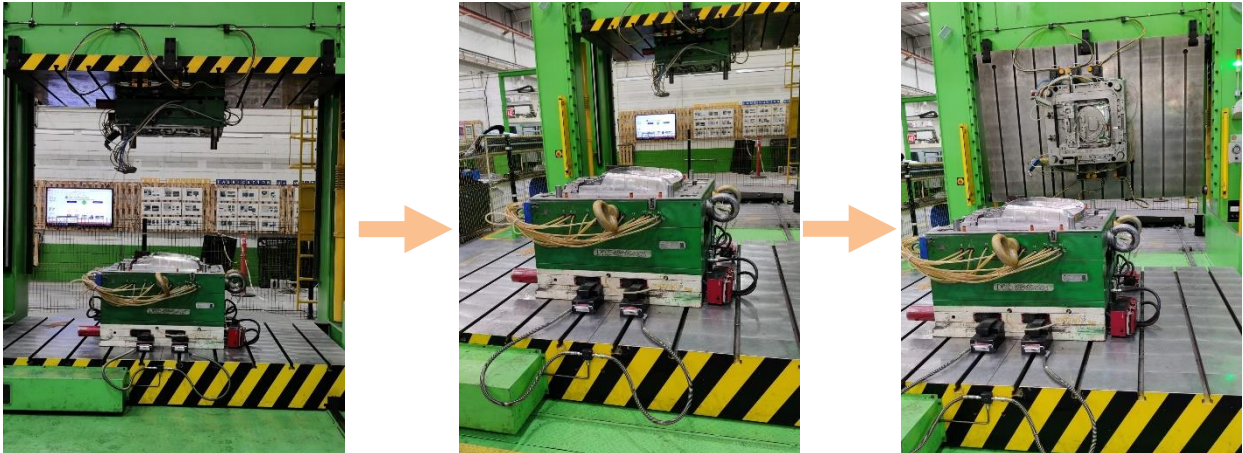
Figura 49 Abertura del molde en la prensa.
