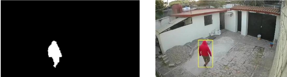
Figura 5.18. Información superpuesta del modelo de fondo y la imagen *RGB* de un objeto en movimiento que pertenece a la clase *persona*..
