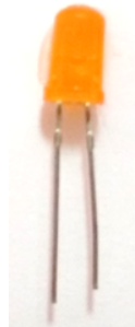
Figura A.10: Visualización de un diodo emisor de luz (LED) de color naranja.
