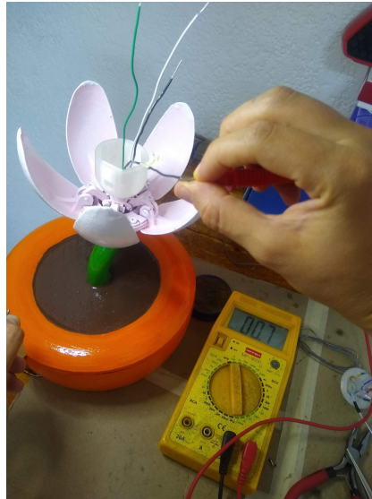
Figura 5.14: Pruebas de continuidad en los cables de los LED's.
