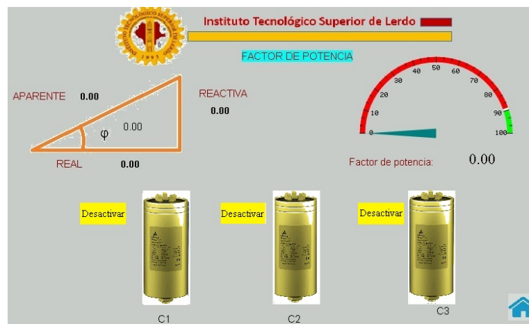
Figura 4.56: Pantalla HMI “01 Factor de Potencia”, capacitor #3 accionado manualmente
