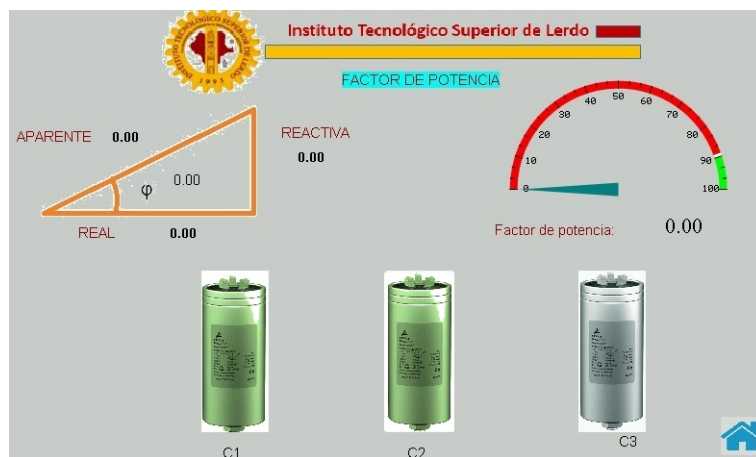
Figura 4.50: Pantalla HMI “01 FACTOR DE POTENCIA”, capacitor 2 energizado.
