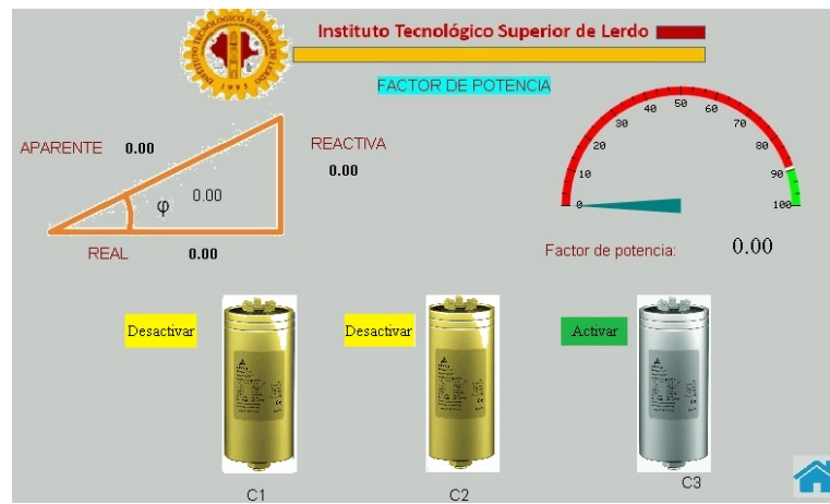
Figura 4.58: Pantalla HMI “01 Factor de Potencia”, capacitor #3 accionado manualmente
