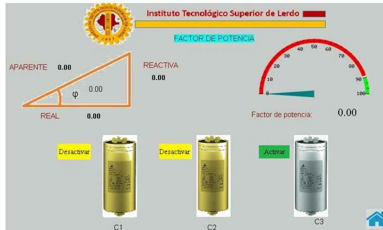
Figura 4.55: Pantalla HMI “01 Factor de Potencia”, capacitor #2 accionado manualmente
