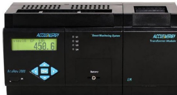
Figura 1.3: Equipo de medición de energía eléctrica AcuRev serie 2000
