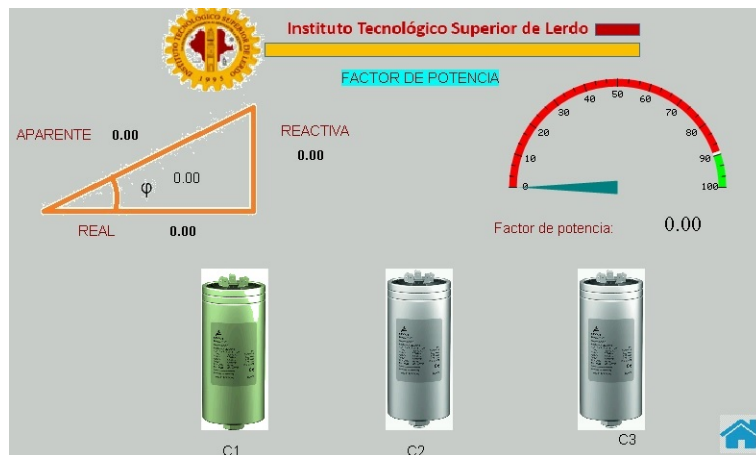
Figura 4.49: Pantalla HMI “01 FACTOR DE POTENCIA”, capacitor 1 energizado.
