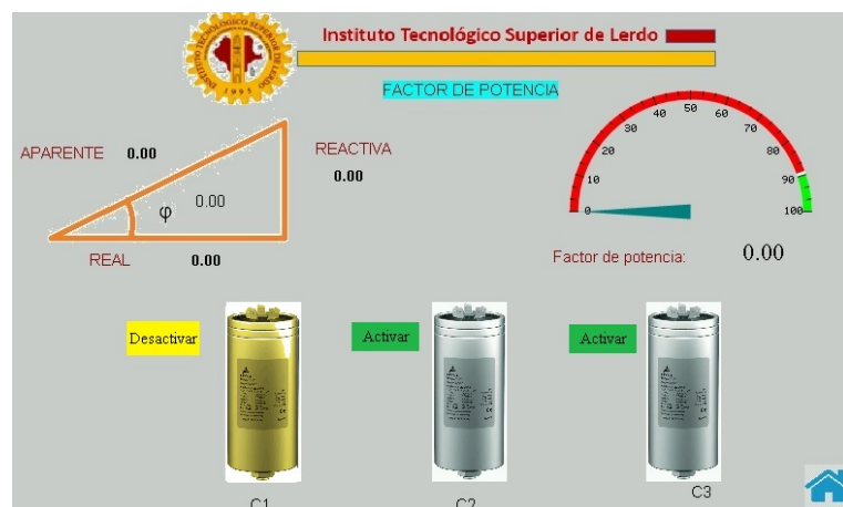
Figura 4.54: Pantalla HMI “01 Factor de Potencia”, capacitor #1 accionado manualmente
