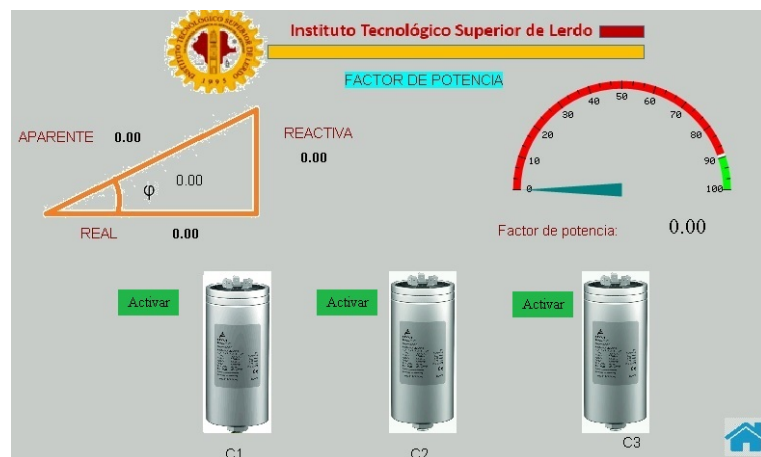
Figura 4.53: Pantalla HMI “01 Factor de Potencia”, los 3 capacitores listos para activarse de modo Manual
