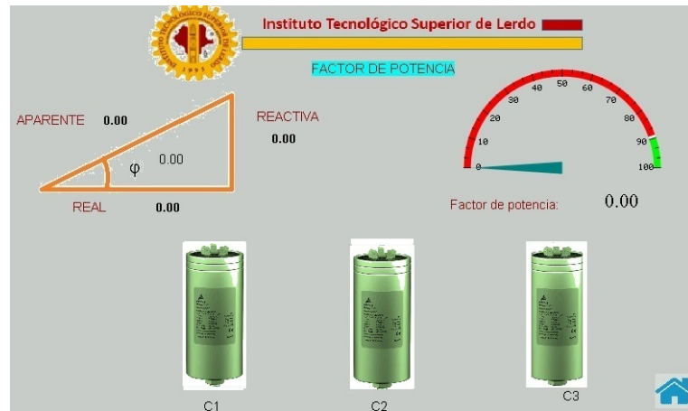
Figura 4.51: Pantalla HMI “01 FACTOR DE POTENCIA” , capacitor 3 energizado.
