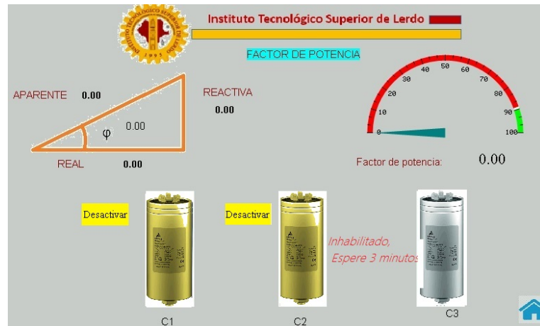
Figura 4.57: Pantalla HMI “01 Factor de Potencia”, capacitor #3 Desactivado manualmente
