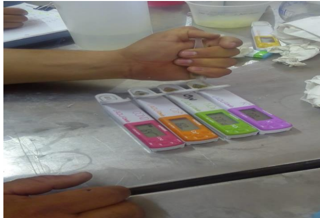
IMAGEN 11: EXTRACCIÓN DE SAVIA Y MEDICIÓN DE NUTRIENTES EN LABORATORIO
