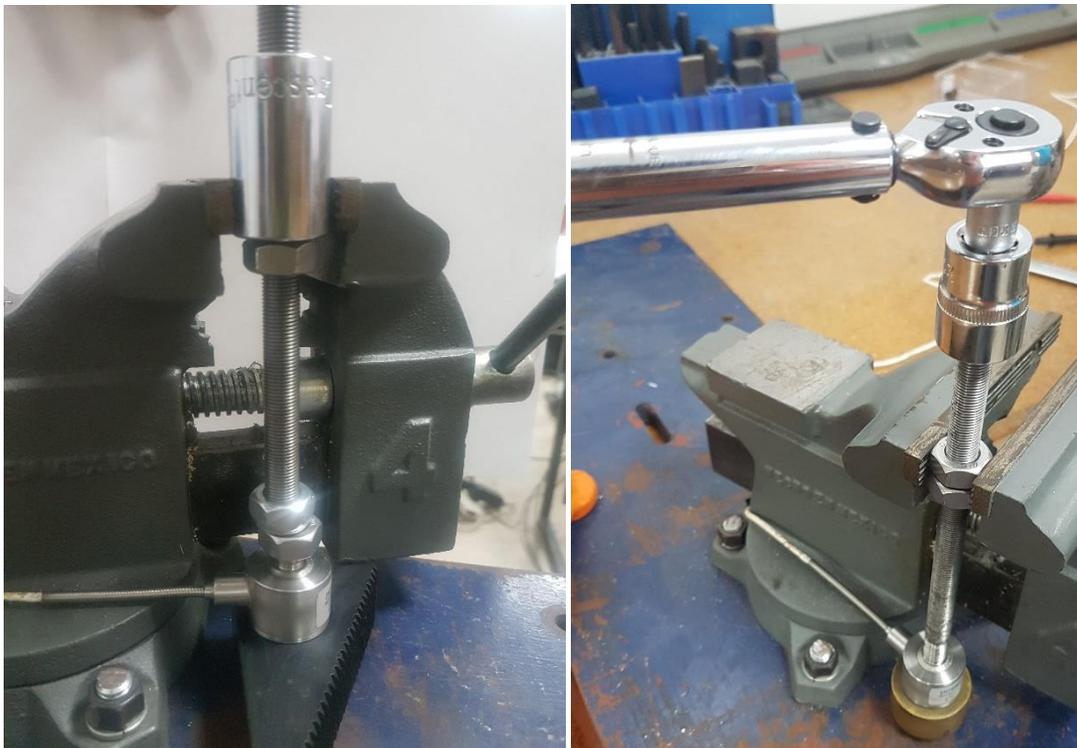
Figura 7.9 Montaje del experimento para medir el apriete dado un torque
