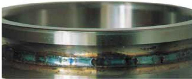
Figura 1.5 Anillo interno de un rodamiento que fallo por exceso de carga [10]
