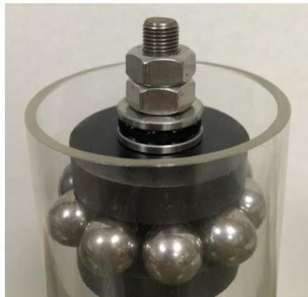
*Figura 5.2 Posición del rodamiento en el dissipador*
