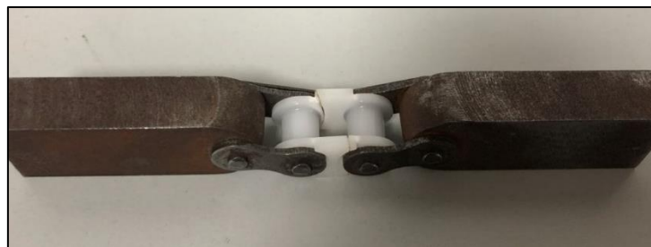
Anexo B- 2. Rotura del elemento plástico
