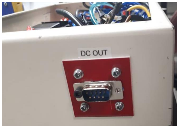
Figura 5.1. Conector DB9 instalado en la fuente de alimentación
