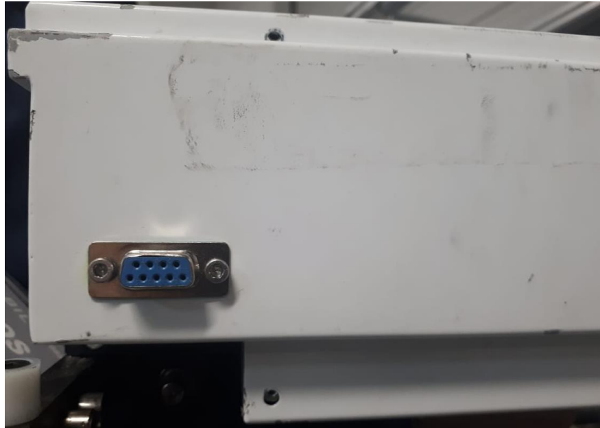
Figura 5.5. Conector DB9 instalado en el feeder pallet
