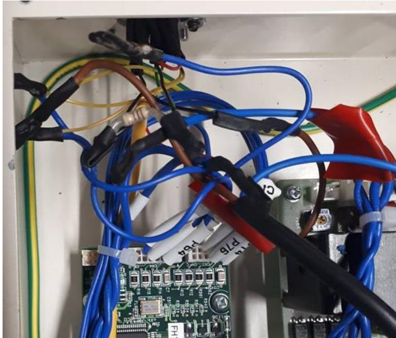
Figura 5.3. Reconexión al conector DB9 en la fuente de alimentación
