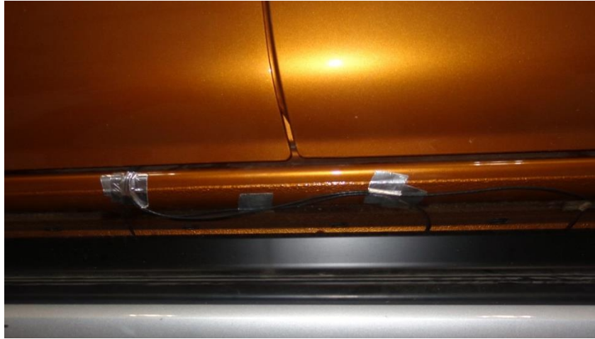
Figura 3.3 Ruteo de conexiones de acelerómetros en un carro instrumentado
