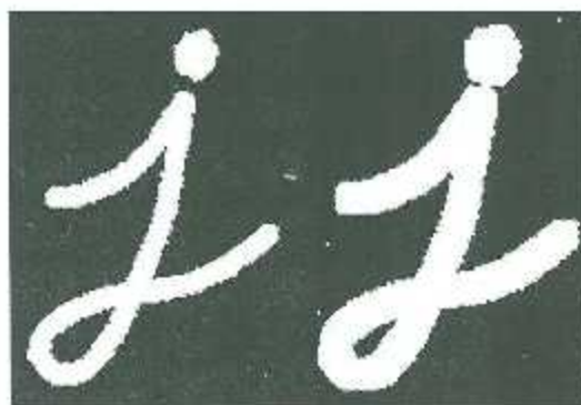
Figura 2.16. Imagen original a la izquierda, imagen dilatada a la derecha [41].
