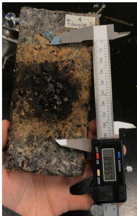
Figura 23. Radio quemado en centímetros.
