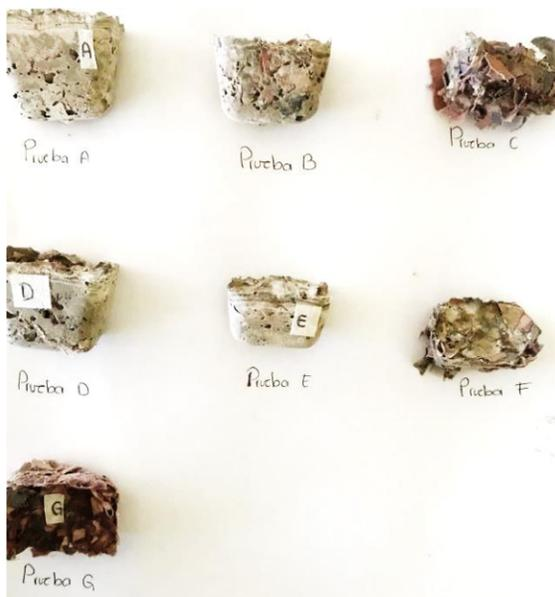
**Figura 8.** Tercera serie de muestras con variación de gramos en la cantidad de cemento de cada muestra.
