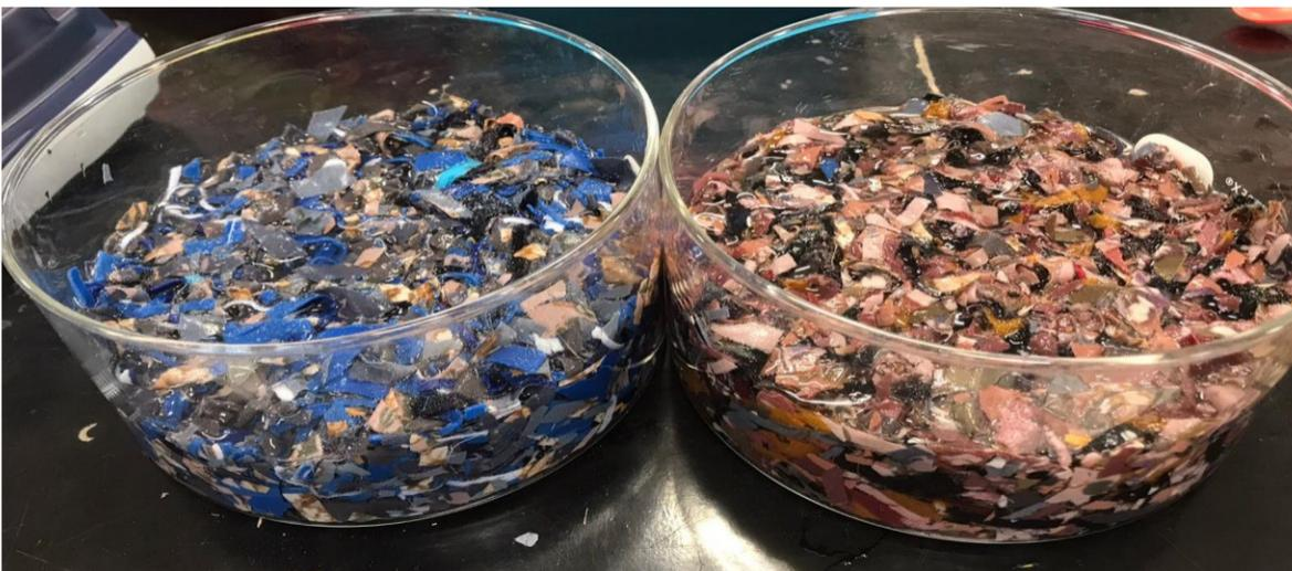
**Figura 4.** Tela en remojo con el mucilago del nopal para un mejor mezclado con los otros materiales.
