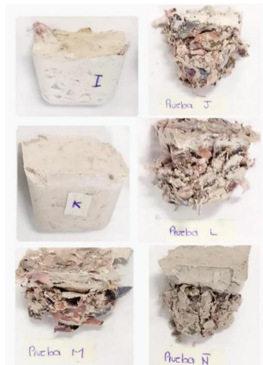
**Figura 6.** Primera serie de muestras secas en distintos moldes.
