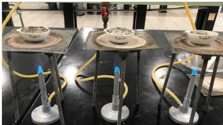
**Figura 11.** Muestras en mecheros para ser secadas.
