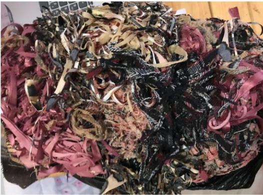
**Figura 2.** Tela desechada y triturada por la maquina Overlock.
