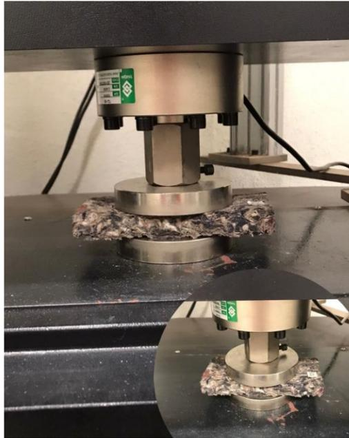
Figura 24. Prueba de compresión.
