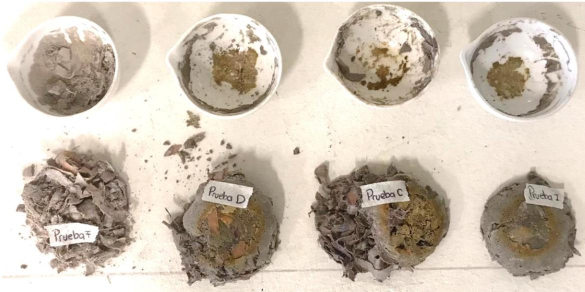
Figura 12. Muestras ya secas empleando el mechero y retiradas de las capsulas de porcelana.
