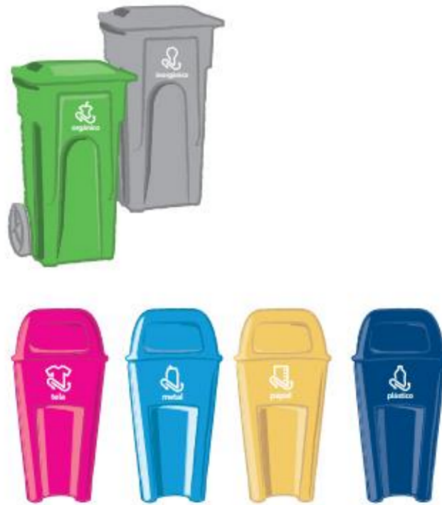
Imagen 29. Aplicación de colores para cada contenedor de acuerdo con su tipo de residuo.
