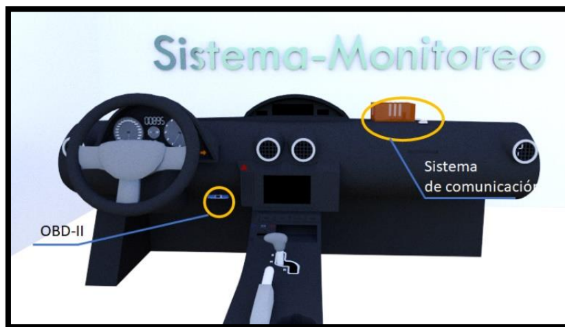
Figura 51 Disposición del Sistema de comunicación (autoría propia)
