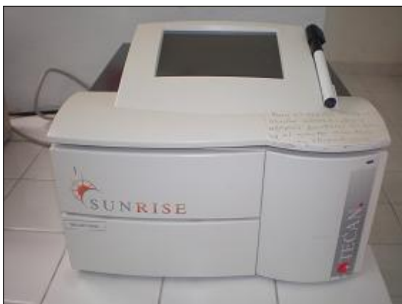
Figura 19. Lector tipo SUNRISE Touchscreen marca TECAN utilizado en la técnica ELISA.
