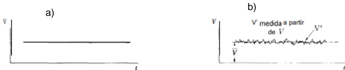
Figura 68. a) Flujo laminar permanente, b) turbulento permanente. Medición de V (Jardón, s.f.)
