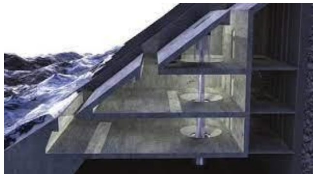
Figura 21. Seawave Slote-cone Generator (Vicinanza, et al., 2015)
