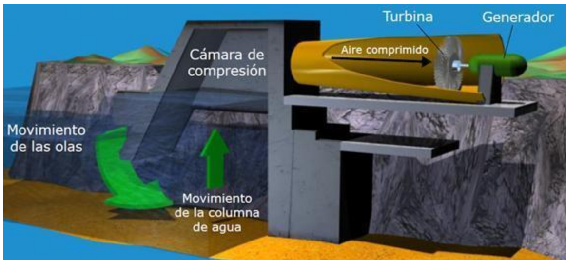
Figura 22. Partes de una central OWC (Valdéz, 2013)
