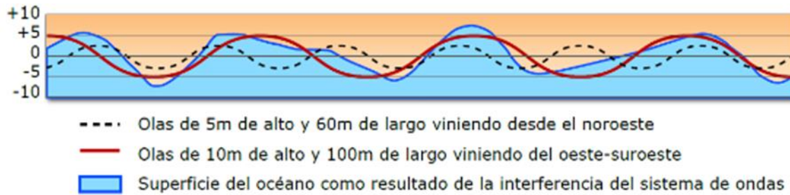
Figura 49. Superposición de ondas de un estado típico del mar (Durán, 2017)
