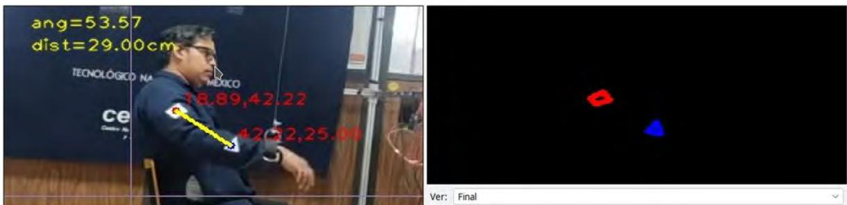
Figura 32 Del lado izquierdo se muestra la imagen procesada y a la derecha los contornos encontrados.
