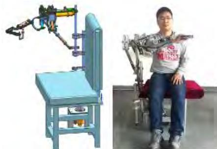
Figura 10 Diseño y prototipo virtual del robot de 7 GDL Rehab Arm (Liu et al., 2016).
