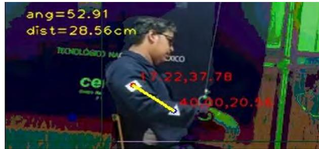
Figura 31 Máscara sobre puesta sobre la imagen procesada utilizando la operación AND en los pixeles para la ubicación de la imagen.
