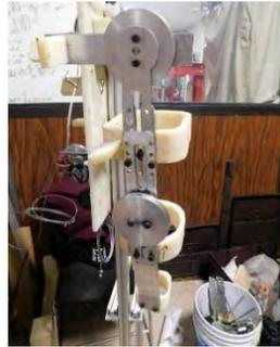
Figura 3 Plataforma experimental: mecanismo para emular una extremidad superior (Vázquez et al., 2019).
