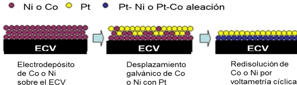
Figura 10. Esquema del proceso de preparación de los electrocatalizadores binarios Pt-Co y Pt-Ni.
