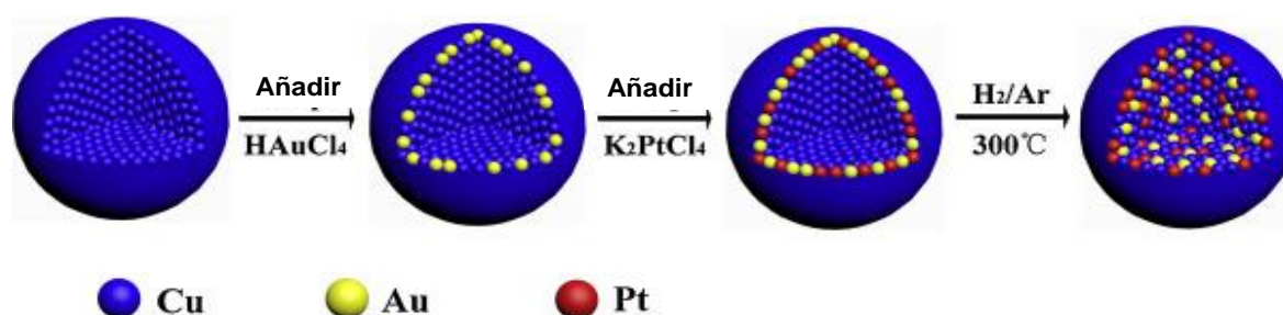
Figura 6. Ilustración del procedimiento de síntesis del electrocatalizador PtAuCu/C.
