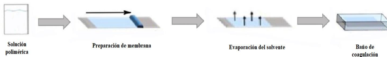
Figura 10. Método de IF para preparación de membranas soportes.
