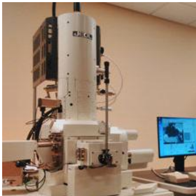
Figura 32. Microscopio Electrónico de Barrido de Emisión de Campo FESEM, JEOL Mod. JSM-7800 Prime acoplado con un sistema de análisis elemental por dispersión de energía de rayos X (EDS).
