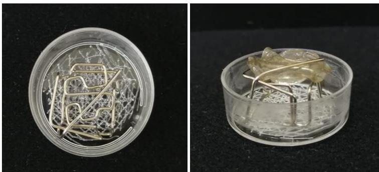
Figura 18. Cámaras para la reticulación en vapor
