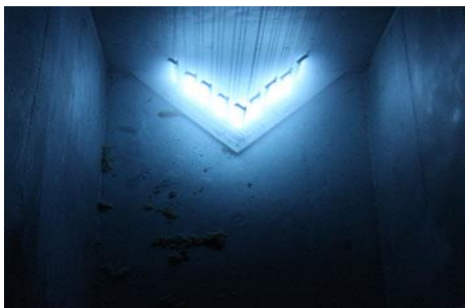
Figura 22. Fuente de radiación del Irradiador Gammabeam 651PT ^{60}\text{Co} tipo alberca profunda.
